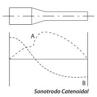
Atenção: Para construir ou modificar um sonotrodo, é importante usar um analisador para tal finalidade (ex. analisador Efrasônic modelo EF-2000) porque qualquer variação na sua geometria altera a frequência ideal das vibrações. Quando um sonotrodo operar em frequência inadequada, poderá provocar sérios danos ao transdutor e ao gerador, anulando as condições de garantia.
